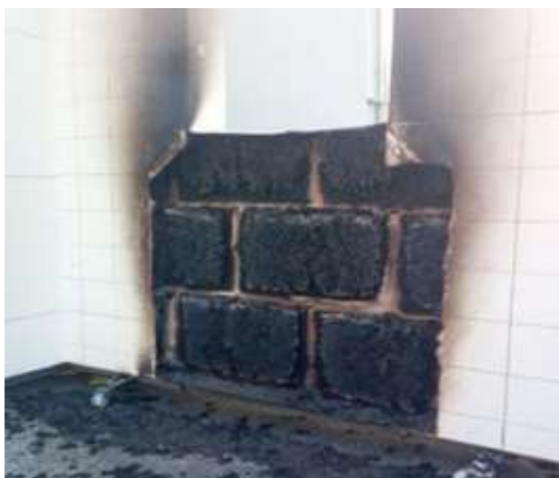
TEST - SISTEMI ETICS CON ISOLANTI COMBUSTIBILI IN FIBRA DI LEGNO
