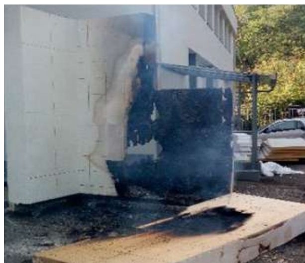
TEST - SISTEMI ETICS CON ISOLANTI COMBUSTIBILI IN FIBRA DI LEGNO
