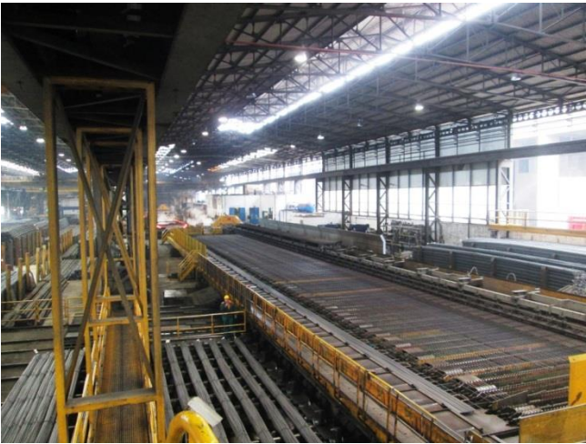
Placca di raffreddamento, lunghezza 54 m per laminati fino a 48 metri di lunghezza
