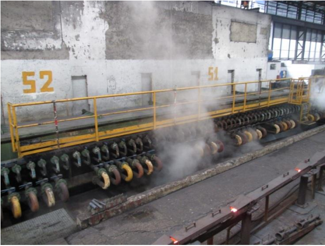
Tempcore con 6 linee per il trattamento termico del laminato
