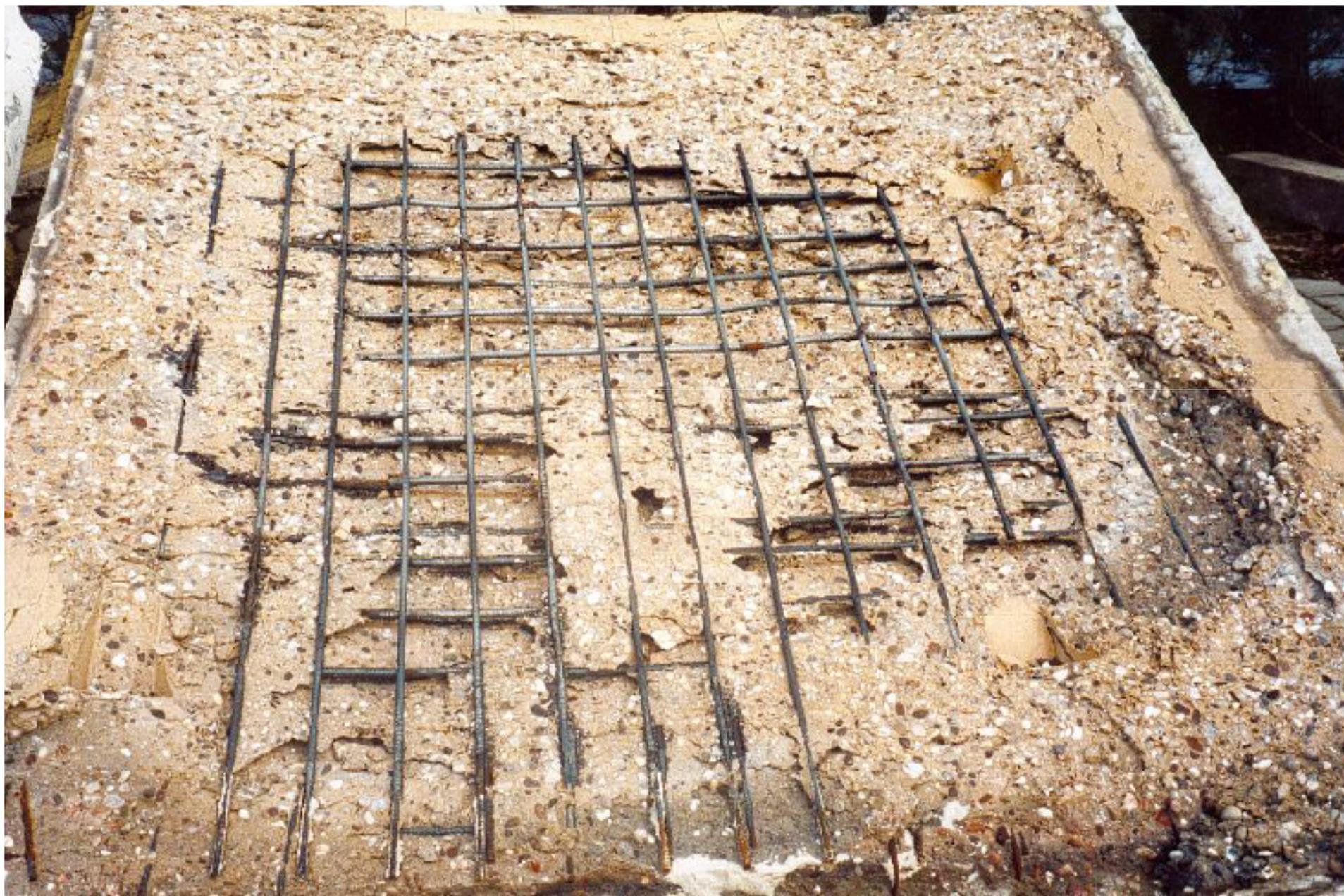
L'effetto dello spalling con l'impiego di  $2 \text{ kg/m}^3$  di fibra polipropilenica
