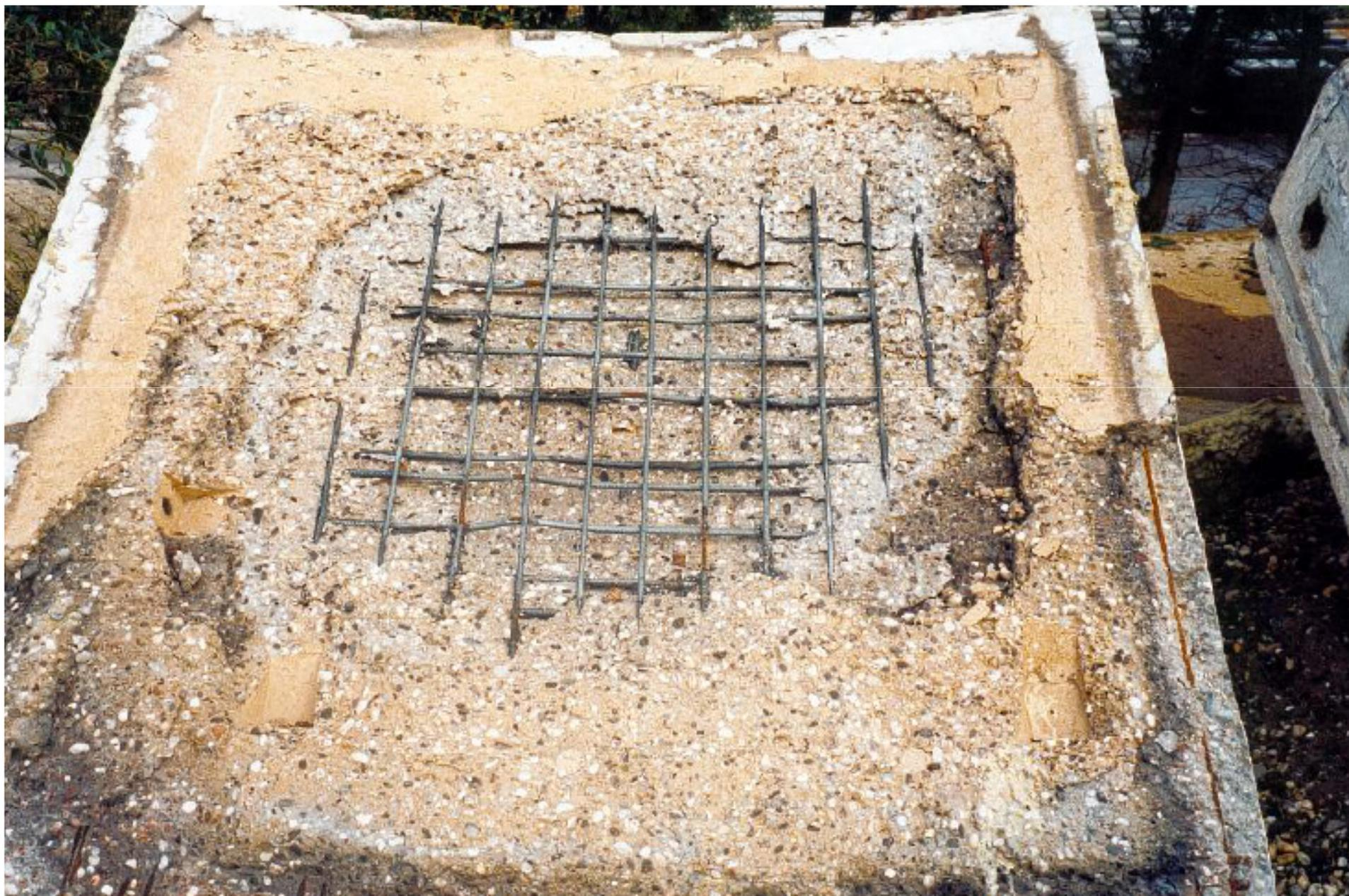
L'effetto dello spalling con l'impiego di  $3 \text{ kg/m}^3$  di fibra polipropilenica
