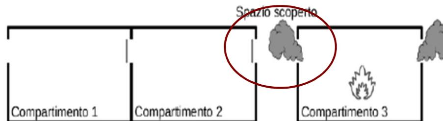
I compartimenti 1 e 2 sono a *prova di fumo* proveniente dal compartimento 3 e viceversa.
