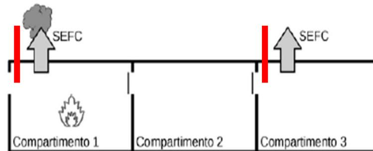
Il compartimento 2 è a *prova di fumo* proveniente dai compartimenti 1 e 3.
