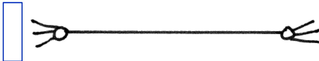
Elevato stato tensionale di compressione, possono verificarsi fenomeni di instabilità.
