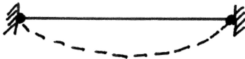
Stato di deformazione elevata per combinazione degli effetti, fenomeni del 2° ordine, plasticizzazione, "effetto catena" (acciaio).
